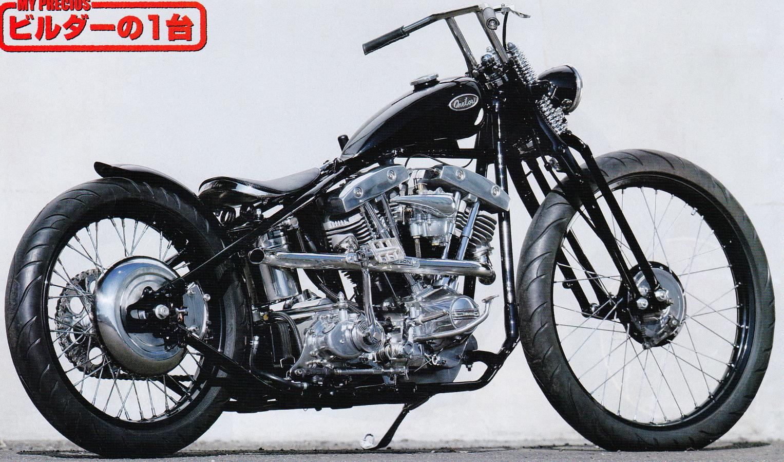
先端を丸く削るスプーンペダルは四輪の手法。ベグは純正のラバーレス。アイデア次第でカッコ良くなるお手本。
